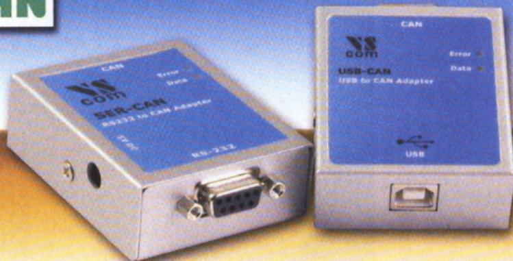
**Vision Systems:** Mit den VScom CAN-Adapttern kann ein PC auf einfache Art an den CAN-Bus angeschlossen werden. Die Anbindung erfolgt auf zwei unterschiedliche Arten, per USB-Schnittstelle mit dem USB-CAN und per RS232 mit dem SER-CAN Adapter. Der Adapter wird über den USB 2.0-Port mit dem PC verbunden. Auch USB 1.1 mit der Full Speed Datenrate von 12 Mbit/s ist für den Betrieb geeig-
