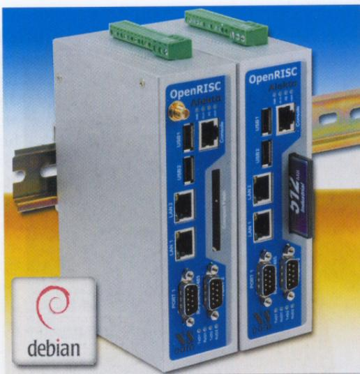
Der Vorteil der RISC-Architektur liegt in ihrer geringen Leistungsaufnahme, dem robusten Aufbau, der Einsatzmöglichkeit für den erweiterten Temperaturbereich, sowie Kostenreduzierung gegenüber den x86-Systemen.
