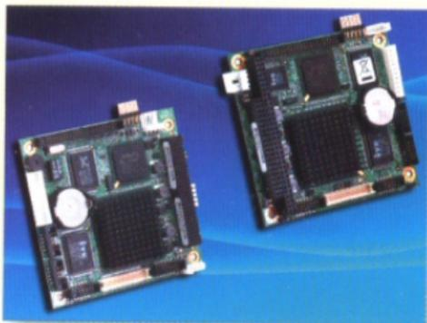
GB Speicher unterstützt. Für die optionale Bestückung mit Massenspeichern sind ein IDE-CompactFlash-Sockel sowie ein 44-Pin-2,0-mm-IDC-Stecker zur Aufnahme von 2,5"-Festplatten implementiert. Des Weiteren kann die Möglichkeit zur individuellen Funktionserweiterung über einen PC/104-Bus (ISA) in der Baugruppe VS 2612 und über PC104/plus (PCI) in der VS 2616-Platine genutzt werden.
